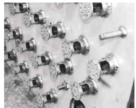
Рассекатели газожидкостных фонтанов высокодисперсного распределения (патент №2281804)
