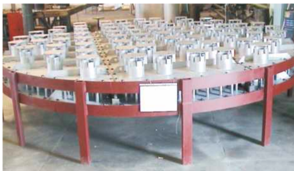
Контрольная сборка распределительных тарелок на макет-имитаторе реактора диаметром 3,6 м.
