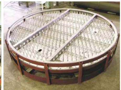
Рассекатели газожидкостных фонтанов высокодисперсного распределения (патент №2281804)
