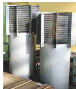
Верхние распределительные устройства
